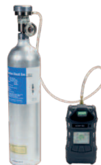
Kézi teszt tesztgázzal
